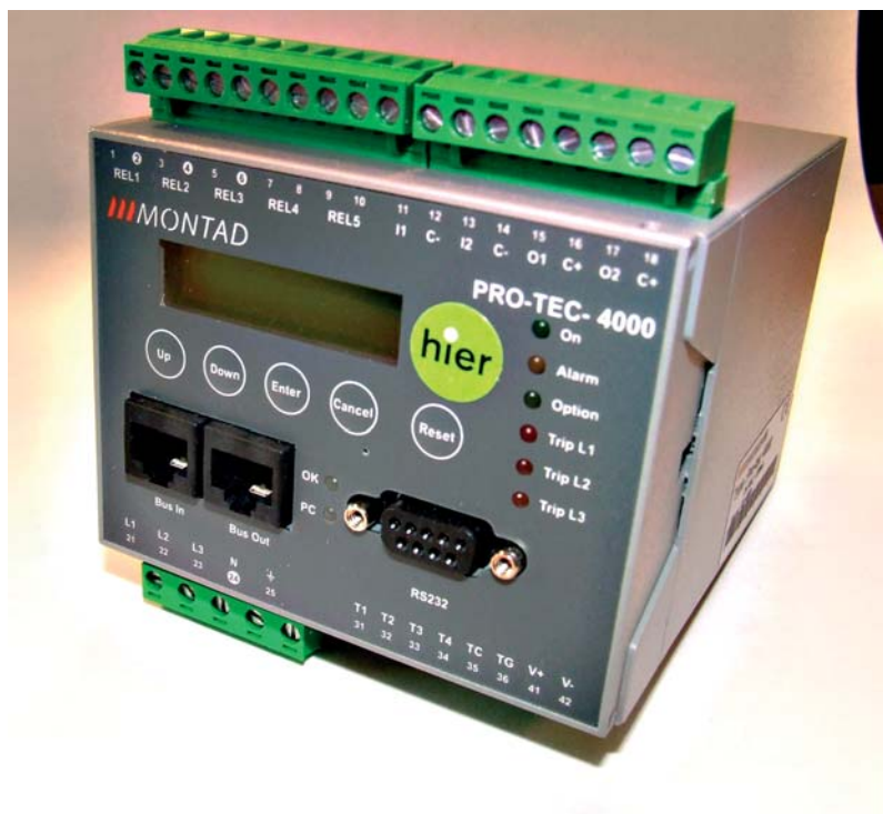
Hart van het kabelbeveiligingssysteem van Montad, de regelunit Pro-Tec 4000.
